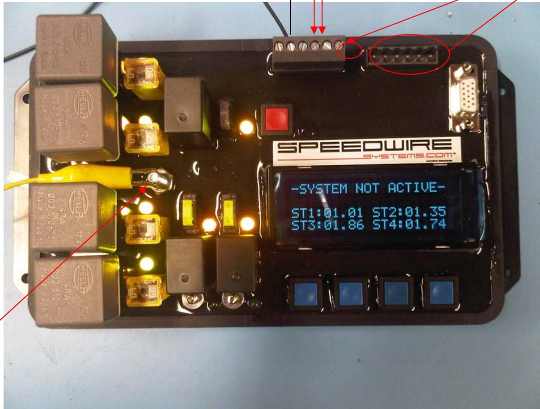
MAIN BATTERY POWER 6 GAUGE FOR 4 SYSTEMS 8 GAUGE FOR 2 SYSTEMS
